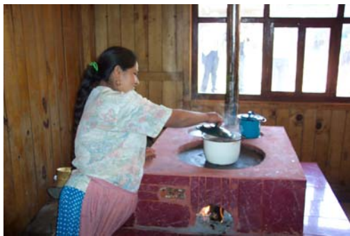
Figura 3b. Aspecto del interior de algunas cocinas con la estufa "Patsari"
